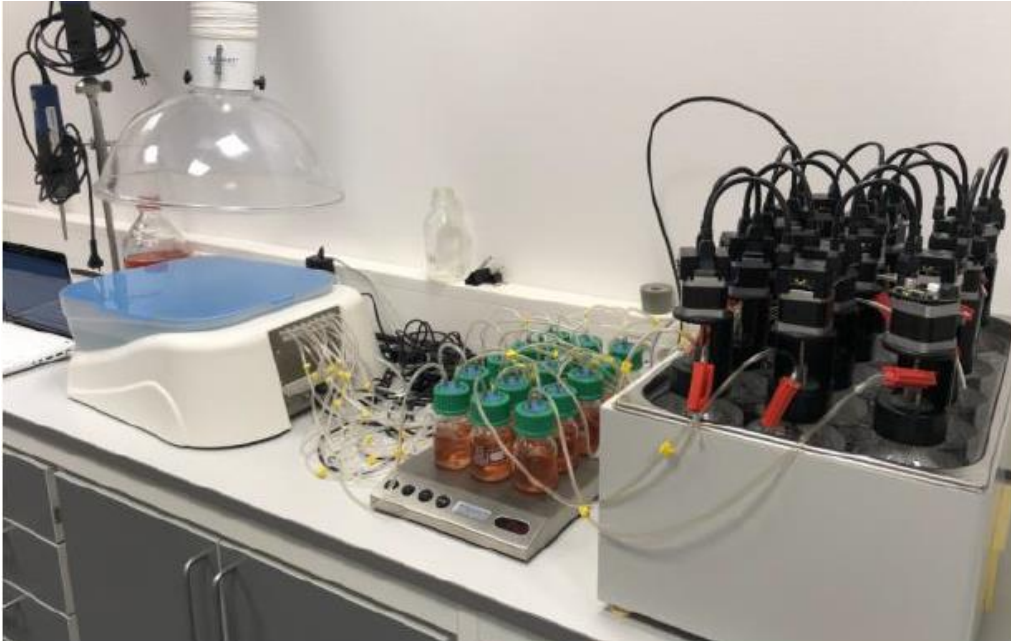
Figur 2. Lab-utstyr for måling av biogasspotensiale (AMPTS® II) (bilde: Aquateam COWI).
